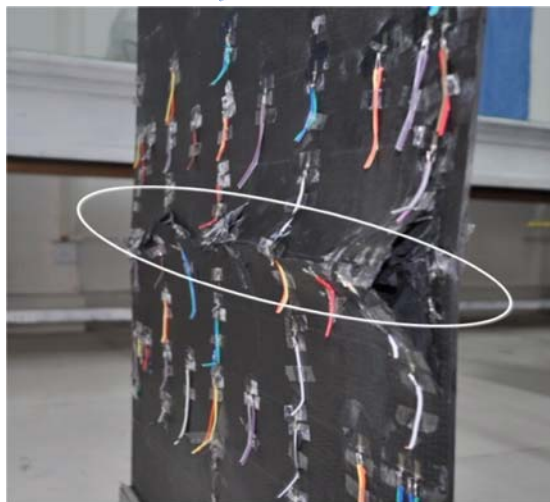
(b) 壁板撕裂
